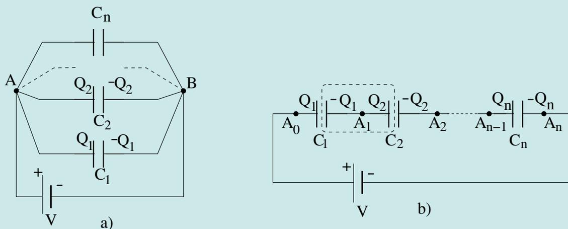
FIGURE 3.11 – Association de condensateurs a) en parallèle, (b) en série.
