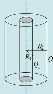
FIGURE 3.10 – Capacité d'un condensateur cylindrique.
