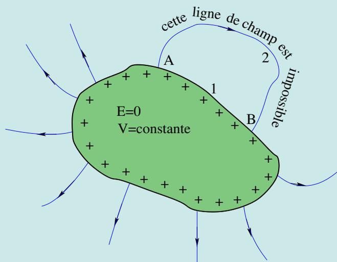
FIGURE 3.1 – La circulation de  $\vec{E}$  de  $A$  à  $B$  est impossible suivant le chemin 2 si  $A$  et  $B$  sont deux points de la surface d'un conducteur en équilibre électrostatique.
