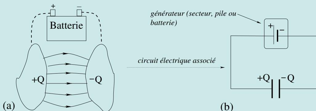
FIGURE 3.5 – Chargement des armatures avec une batterie.
