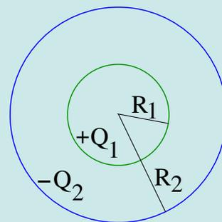
FIGURE 3.9 – Capacité d'un condensateur sphérique.
