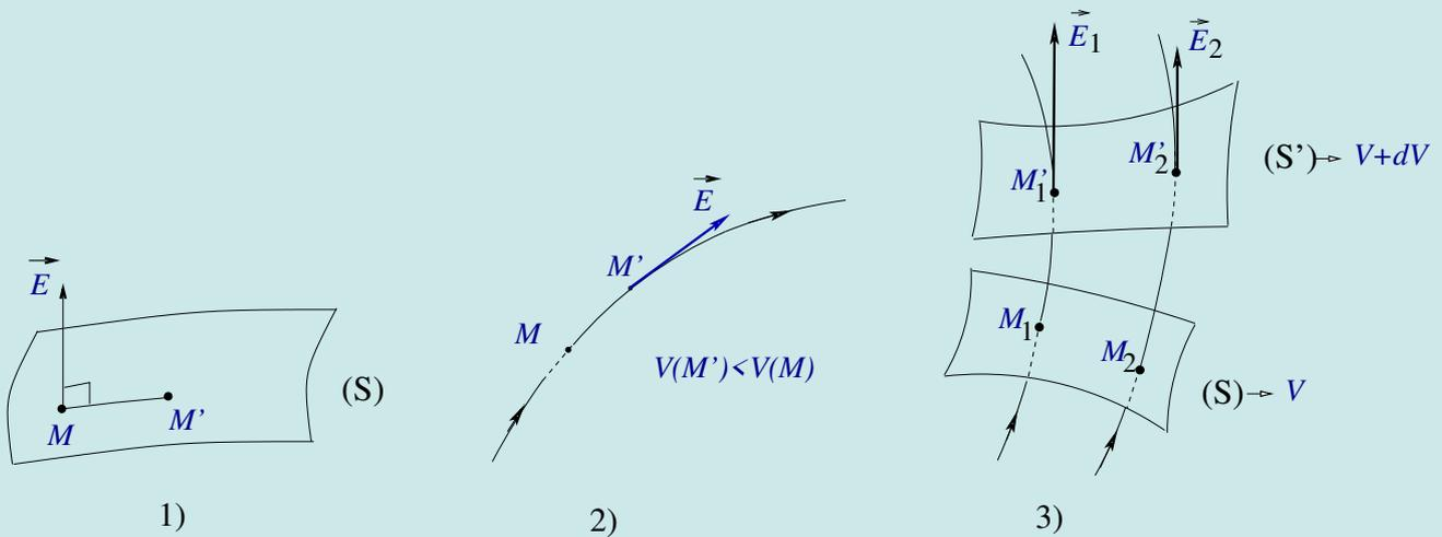
FIGURE 2.8 – 1) Lignes de champ  $\perp$  aux surfaces équipotentielles ; 2) Le potentiel diminue le long d'une ligne de champ ; 3) Surfaces équipotentielles plus serrées dans les régions de champ intense
