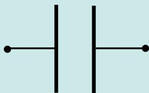
FIGURE 3.6 – Symbole du condensateur dans un schéma normalisé d'un circuit électrique.
