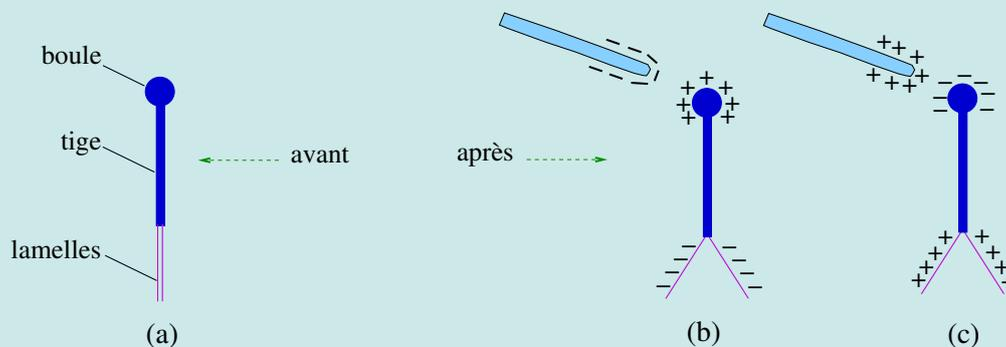
répulsion des lamelles. Voici l'explication. Si la baguette est chargée négativement, elle repousse les électrons libres de l'électroscope. Ces électrons se retrouvent en excès dans les lamelles qui deviennent chargées négativement et se
