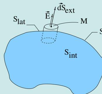
FIGURE 3.4 – Champ au voisinage d'un conducteur.
