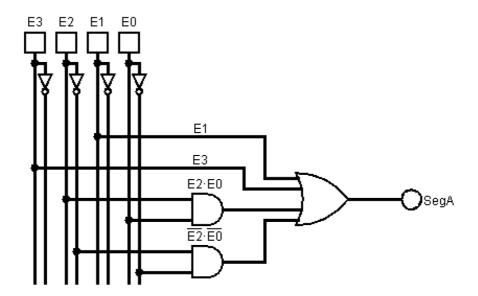
• **Remarque :** La réduction dans le nombre des portes est très importante, ça permet de réduire le cout du circuit, de le rendre plus rapide, de réduire sa consommation électrique, et de simplifier sa réalisation physique.
